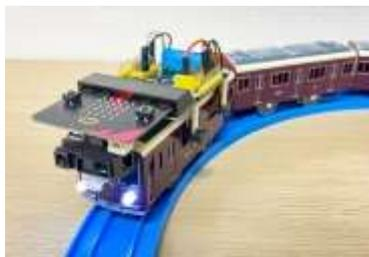
などなど、プラレールを自在に操るための部品を取り付けていきます。さらに micro:bit というマイコンボードも載せて、取り付けられた部品をプログラムでコントロールできるようにします。プログラミングと言ってもブロックをつなぎ合わせるパズルのようなものなので、誰でも簡単に作れちゃいます。改造が終わったら、レールの上を自由に走らせたり、人とは違う自分だけの特別な動きをするプラレールに変更したりしてみよう。
